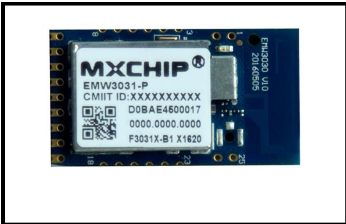
整体照 物理尺寸：长 X 宽 X 高=18mm(L)X 33mm(W)X 3.3mm(H)
