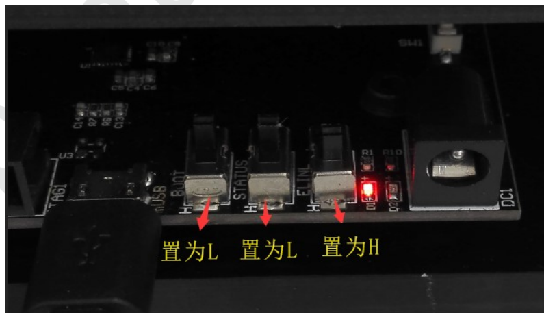
图 3.8 测试模式的开关设置
