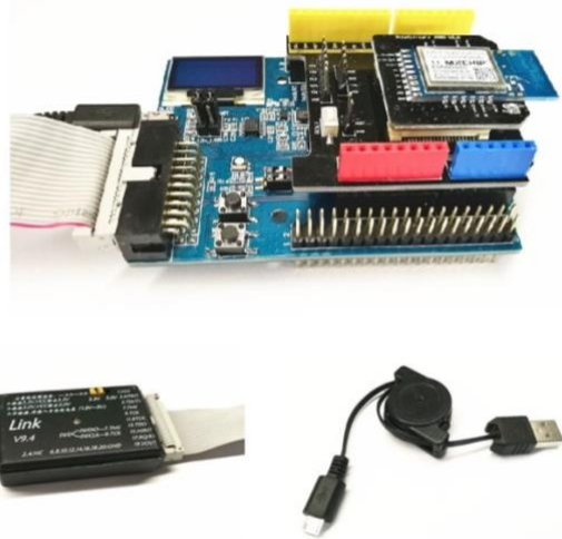
图 4.4 MXKit Hosted 套件开发硬件清单
