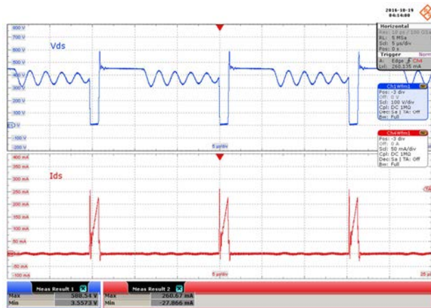
Figure 31 – 265 VAC Input. Upper: V_{DS} , 100 V / div. Lower: I_{DS} , 50 mA / div., 5 \mu s / div. V_{DSMAX} : 588.54 V. I_{DSMAX} : 260.67 mA.
