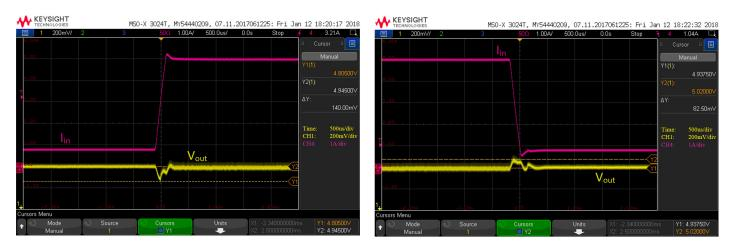
Figure 6.1. Si34061-ISO-FB EVB PD Output Step Load Transient Test
